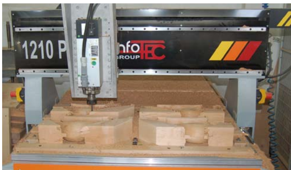
Na ploterze marki InfoTec frezowane są drewniane ozdoby. FOT. IRENA MUSZAŁOWSKA
